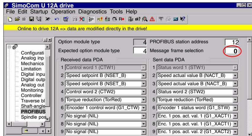
Fig. 18-4 Activating the customizable message frame configuration
