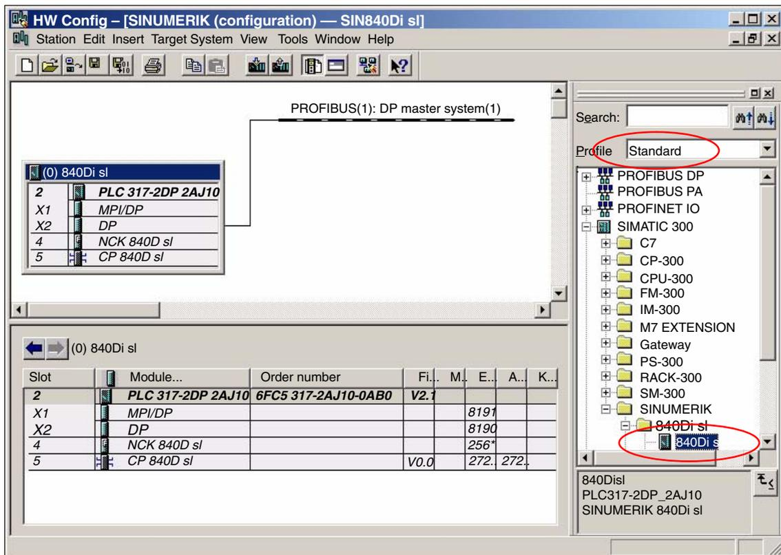
Fig. 6-5 HW Config: SINUMERIK 840Di sl Rack
