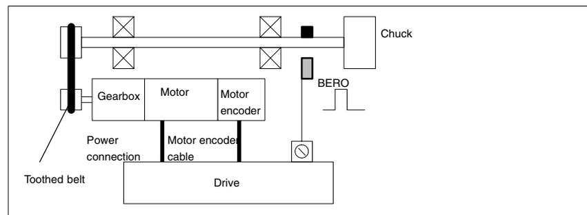
Fig. 11-29 Synchronization using BERO
