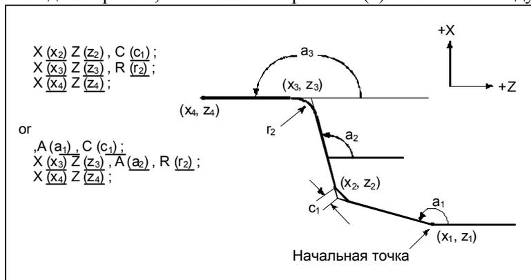
**Рис. 4.9 (а) Чертеж обработки детали (пример)**
