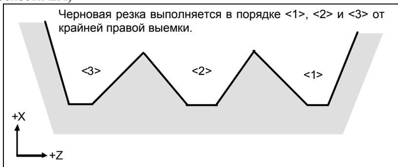
Рис. 6.4.1 (m) Порядок чернового резания в случае монотонного убывания (тип II)
