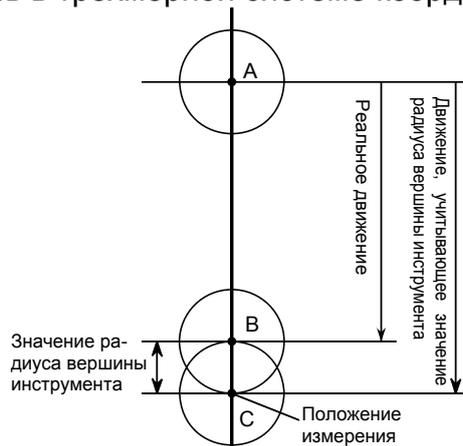
В действительности инструмент перемещается из точки А в точку В, но величина коррекции на инструмент определяется с учетом величины радиуса вершины инструмента, предполагая, что инструмент перемещается в точку С.
